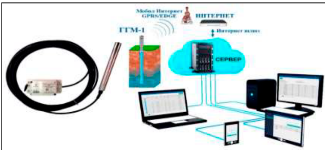
2-rasm. Avtomatlashtirilgan monitoring tizimini amalga oshirish qurilmasi vositalarining tuzilishi
